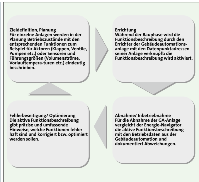
Bild 8: Alle beschriebenen Leistungen – die Erstellung der Funktionsbeschreibung, die Dokumentation und Adressierung sowie die Prüfung der Funktionen als Abnahme der GA-Anlagen – fügen sich in vorhandene Leistungsbilder am Bau ein
